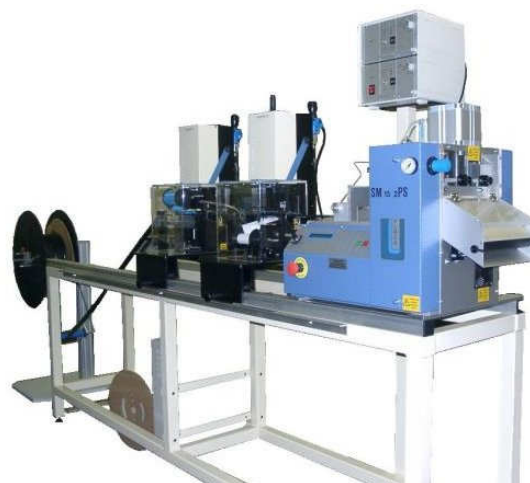
Automatische Markier- und Schneidstation für Kabel und Schläuche
