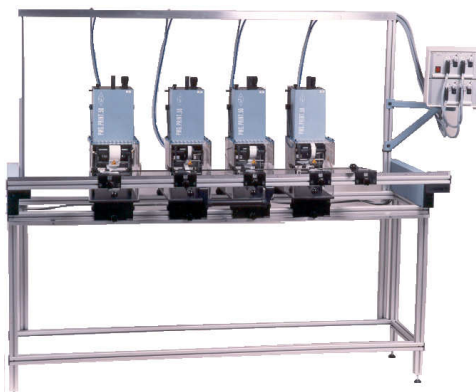
Handbetriebene Mehrkopfanlage mit Einlegeschlitten für Ring- und Textbedruckung
