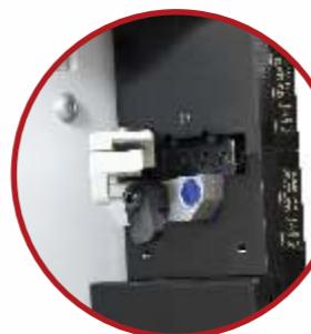
Adapter für WEZAG CK 100/ CS 30 Einsätze (Typ: GAP WEZAG) Adapter for WEZAG CK 100/ CS 30 die sets (Type: GAP WEZAG) Adaptateur pour matrices WEZAG CK 100/CS 30 (Type: GAP WEZAG)
